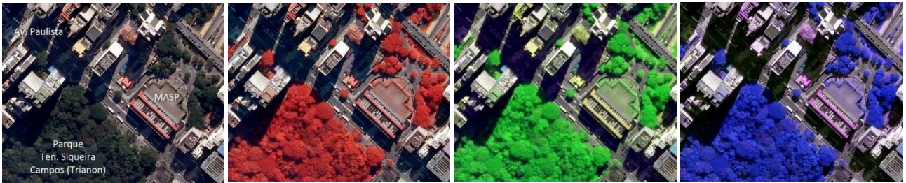
Ejemplo de ortoimágenes en color verdadero e infrarrojo combinadas en las bandas espectrales R, G e B.
