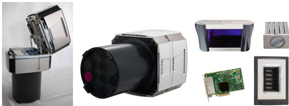
En la imagen de la izquierda se visualiza el equipo con el sensor (parte inferior del equipo) y el módulo de la computadora de Eagle (parte superior del equipo). En la imagen central se visualizan los conos CCD y en las restantes imágenes los otros componentes del equipamiento.
