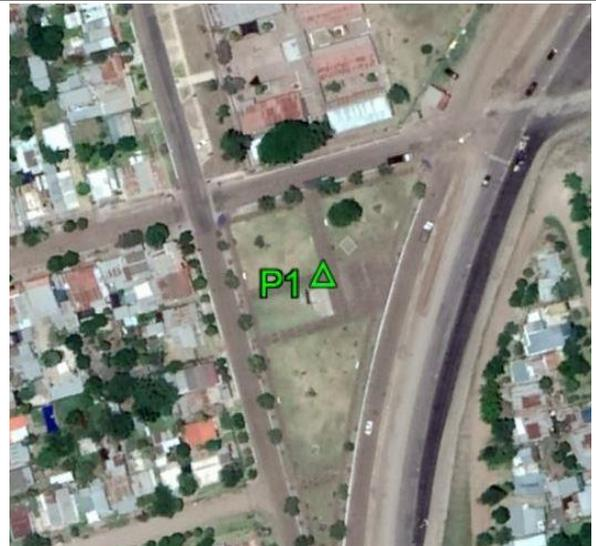
**Fecha:** 22/02/2018**Modo de Levantamiento:** Estático**Tipo / Modelo de antena utilizado:** Trimble/ R6-4 Internal**Altura / Tipo de Medición de la antena:** 2,000 / Base del montaje**Nombre de archivo Rinex:** P1\_0533**Observaciones:** Punto recogido en el canto de de la calzada. Todas las unidades estan en metros.**Ejecutado por:****Topocart - Topografía, Engenharia e Aerolevanteamento S/S Ltda.**
