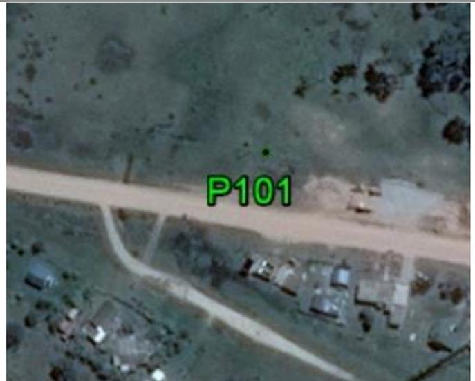
**Fecha: 23/02/2017****Modo de Levantamiento: RTK****Tipo / Modelo de antena utilizado: Trimble/ R6-4 Internal****Altura / Tipo de Medición de la antena: 2,000 / Base del montaje****Nombre de archivo Rinex: -****Observaciones: Punto recogido en la esquina de la cerca. Todas las unidades están en metros****Ejecutado por:****Topocart - Topografía, Engenharia e Aerolevantamento S/S Ltda.**
