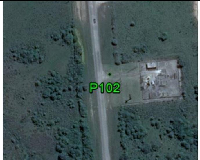
**Fecha: 23/02/2017****Modo de Levantamiento: RTK****Tipo / Modelo de antena utilizado: Trimble/ R6-4 Internal****Altura / Tipo de Medición de la antena: 2,000 / Base del montaje****Nombre de archivo Rinex: -****Observaciones: Punto recogido en el canto de la acera. Todas las unidades están en metros****Ejecutado por:****Topocart - Topografía, Engenharia e Aerolevanteamento S/S Ltda.**
