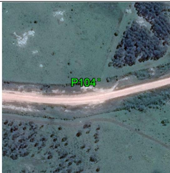
**Fecha:** 23/02/2017**Modo de Levantamiento:** RTK**Tipo / Modelo de antena utilizado:** Trimble/ R6-4 Internal**Altura / Tipo de Medición de la antena:** 2,000 / Base del montaje**Nombre de archivo Rinex:** -**Observaciones:** Punto recogido en la esquina de la cerca. Todas las unidades están en metros.**Ejecutado por:****Topocart - Topografía, Engenharia e Aerolevantamento S/S Ltda.**
