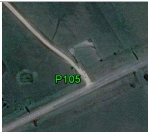
**Fecha: 23/02/2017****Modo de Levantamiento: RTK****Tipo / Modelo de antena utilizado: Trimble R6-4 Internal / AR20 w/LEIM Dome****Altura / Tipo de Medición de la antena: 2,000m / Base del montaje****Nombre de archivo Rinex: -****Observaciones: Punto recogido en la esquina de la cerca. Todas las unidades están en metros****Ejecutado por:****Topocart - Topografía, Engenharia e Aerolevanteamento S/S Ltda.**
