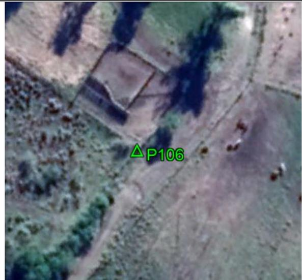
**Fecha: 08/06/2017****Modo de Levantamiento: RTK****Tipo / Modelo de antena utilizado: Trimble/ R6-4 Internal****Altura / Tipo de Medición de la antena: 2,000 / Base del montaje****Nombre de archivo Rinex: -****Observaciones: Punto recogido en la esquina de la cerca. Todas las unidades están en metros.****Ejecutado por:****Topocart - Topografía, Engenharia e Aerolevantamento S/S Ltda.**
