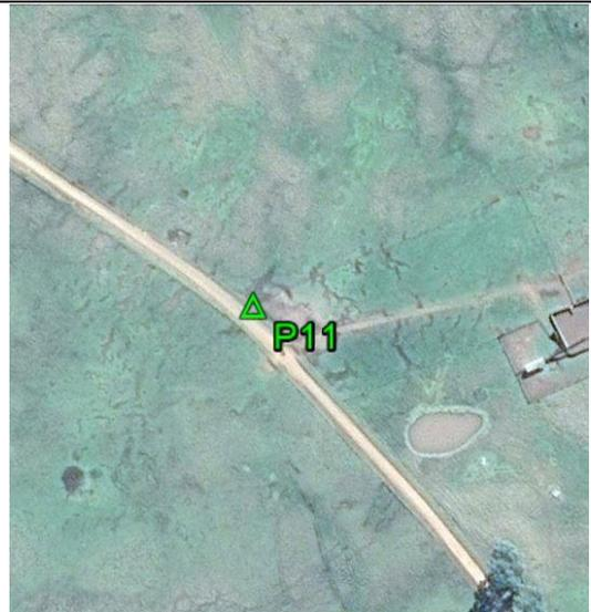
**Fecha:** 28/02/2018**Modo de Levantamiento:** Estático**Tipo / Modelo de antena utilizado:** Trimble/ R6-4 Internal**Altura / Tipo de Medición de la antena:** 2,000 / Base del montaje**Nombre de archivo Rinex:** P11\_0592**Observaciones:** Punto recogido en el canto de la cerca. Todas las unidades están en metros.**Ejecutado por:****Topocart - Topografía, Engenharia e Aerolevantamento S/S Ltda.**
