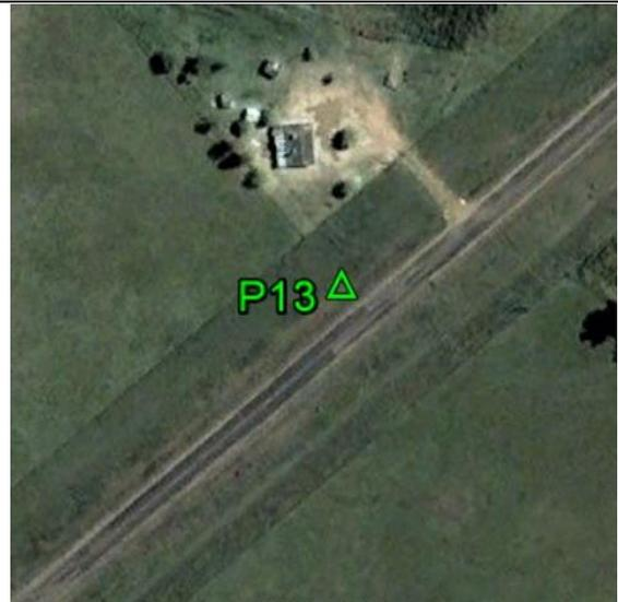
**Fecha:** 27/02/2018**Modo de Levantamiento:** Estático**Tipo / Modelo de antena utilizado:** Trimble/ R6-4 Internal**Altura / Tipo de Medición de la antena:** 2,000 / Base del montaje**Nombre de archivo Rinex:** P13\_0582**Observaciones:** Punto recogido en el canto de la cerca. Todas las unidades están en metros.**Ejecutado por:****Topocart - Topografía, Engenharia e Aerolevanteamento S/S Ltda.**
