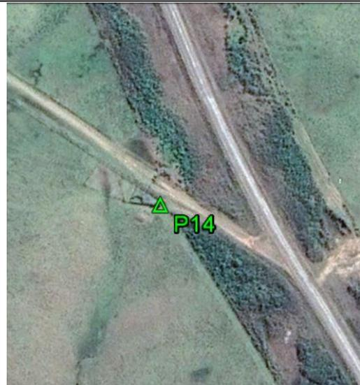
**Fecha: 28/02/2018****Modo de Levantamiento: Estático****Tipo / Modelo de antena utilizado: Trimble/ R6-4 Internal****Altura / Tipo de Medición de la antena: 2,000 / Base del montaje****Nombre de archivo Rinex: P14\_0590****Observaciones: Punto recogido en el canto de la cerca. Todas las unidades están en metros.****Ejecutado por:****Topocart - Topografía, Engenharia e Aerolevantamento S/S Ltda.**
