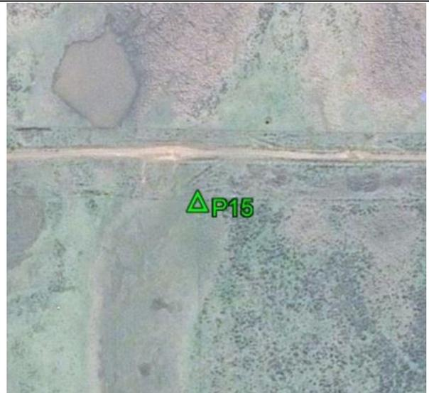
**Fecha: 28/02/2018****Modo de Levantamiento: Estático****Tipo / Modelo de antena utilizado: Trimble/ R6-4 Internal****Altura / Tipo de Medición de la antena: 2,000 / Base del montaje****Nombre de archivo Rinex: P15\_0593****Observaciones: Punto recogido en la esquina de la cerca. Todas las unidades están en metros.****Ejecutado por:****Topocart - Topografía, Engenharia e Aerolevanteamento S/S Ltda.**
