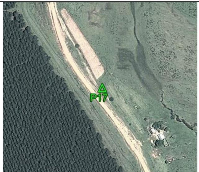
**Fecha: 17/03/2018****Modo de Levantamiento: Estático****Tipo / Modelo de antena utilizado: Trimble/ R6-4 Internal****Altura / Tipo de Medición de la antena: 2,000 / Base del montaje****Nombre de archivo Rinex: P17\_0764****Observaciones: Punto recogido en la esquina de la cerca. Todas las unidades están en metros.****Ejecutado por:****Topocart - Topografía, Engenharia e Aerolevantamento S/S Ltda.**
