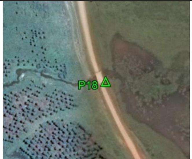
**Fecha: 28/02/2018****Modo de Levantamiento: Estático****Tipo / Modelo de antena utilizado: Trimble/ R6-4 Internal****Altura / Tipo de Medición de la antena: 2,000 / Base del montaje****Nombre de archivo Rinex: P18\_0594****Observaciones: Punto recogido en la esquina de la acera. Todas las unidades están en metros.****Ejecutado por:****Topocart - Topografía, Engenharia e Aerolevantamento S/S Ltda.**
