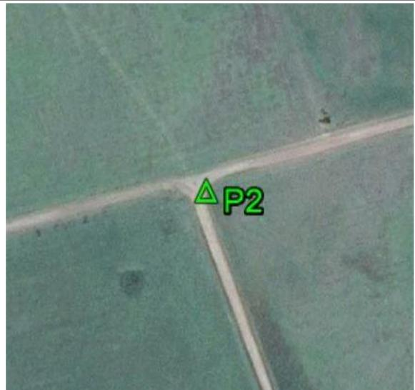
**Fecha:** 07/04/2018**Modo de Levantamiento:** Estático**Tipo / Modelo de antena utilizado:** Trimble/ R6-4 Internal**Altura / Tipo de Medición de la antena:** 2,000 / Base del montaje**Nombre de archivo Rinex:** P2\_0972**Observaciones:** Punto recogido en la esquina de la cerca. Todas las unidades estan en metros.**Ejecutado por:****Topocart - Topografía, Engenharia e Aerolevantamento S/S Ltda.**
