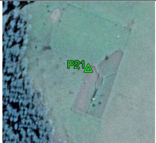
**Fecha: 21/04/2017****Modo de Levantamiento: RTK****Tipo / Modelo de antena utilizado: Trimble/ R6-4 Internal****Altura / Tipo de Medición de la antena: 2,000 / Base del montaje****Nombre de archivo Rinex: -****Observaciones: Punto recogido en la esquina de la cerca. Todas las unidades están en metros.****Ejecutado por:****Topocart - Topografía, Engenharia e Aerolevanteamento S/S Ltda.**
