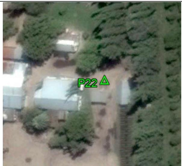
**Fecha:** 21/04/2017**Modo de Levantamiento:** RTK**Tipo / Modelo de antena utilizado:** Trimble/ R6-4 Internal**Altura / Tipo de Medición de la antena:** 2,000 / Base del montaje**Nombre de archivo Rinex:** -**Observaciones:** Punto recogido en el terreno. Todas las unidades están en metros.**Ejecutado por:****Topocart - Topografía, Engenharia e Aerolevantamento S/S Ltda.**
