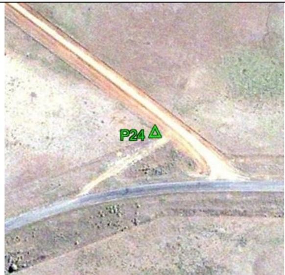
**Fecha: 20/04/2017****Modo de Levantamiento: Estático****Tipo / Modelo de antena utilizado: Trimble/ R6-4 Internal****Altura / Tipo de Medición de la antena: 2,000 / Base del montaje****Nombre de archivo Rinex: P24\_1101****Observaciones: Punto recogido en la esquina de la cerca. Todas las unidades están em metros.****Ejecutado por:****Topocart - Topografía, Engenharia e Aerolevanteamento S/S Ltda.**
