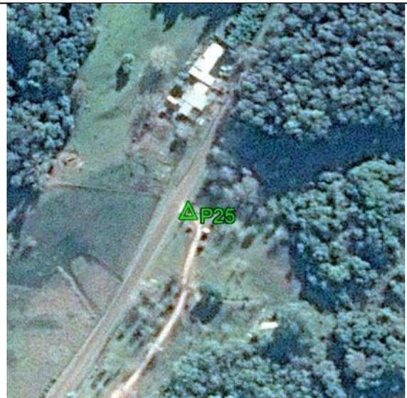
**Fecha: 19/04/2017****Modo de Levantamiento: RTK****Tipo / Modelo de antena utilizado: Trimble/ R8s Internal****Altura / Tipo de Medición de la antena: 2,000 / Base del montaje****Nombre de archivo Rinex: -****Observaciones: El punto fue tomado en el canto del puente. Todas las unidades están en metros.****Ejecutado por:****Topocart - Topografía, Engenharia e Aerolevanteamento S/S Ltda.**
