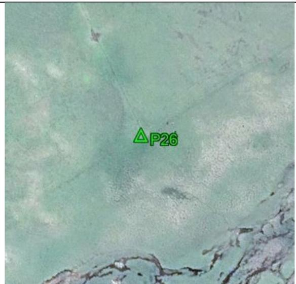
**Fecha: 07/06/2017****Modo de Levantamiento: RTK****Tipo / Modelo de antena utilizado: Trimble/ R8s Internal****Altura / Tipo de Medición de la antena: 2,000 / Base del montaje****Nombre de archivo Rinex: -****Observaciones: Punto recogido en la esquina de la cerca. Todas las unidades están em metros.****Ejecutado por:****Topocart - Topografía, Engenharia e Aerolevanteamento S/S Ltda.**
