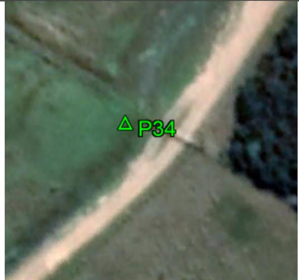
**Fecha: 31/03/2017****Modo de Levantamiento: RTK****Tipo / Modelo de antena utilizado: Trimble/ R6-4 Internal****Altura / Tipo de Medición de la antena: 2,000 / Base del montaje****Nombre de archivo Rinex: -****Observaciones: Punto recogido en la esquina de la cerca. Todas las unidades están en metros.****Ejecutado por:****Topocart - Topografía, Engenharia e Aerolevantamento S/S Ltda.**
