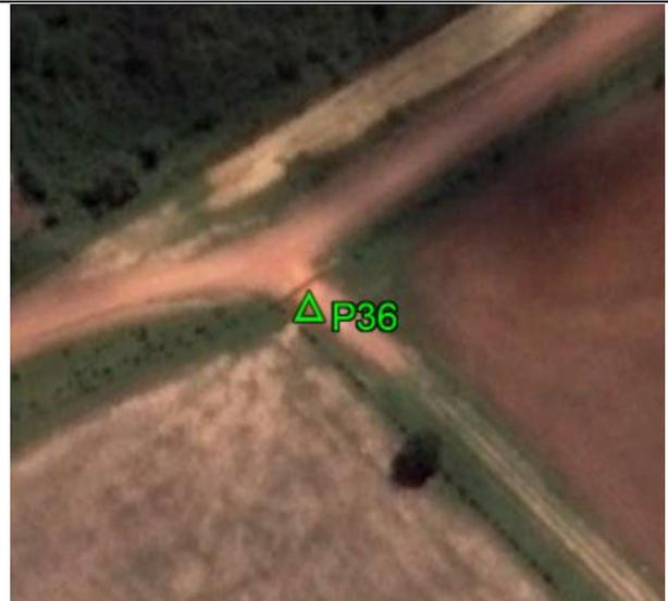
**Fecha: 15/05/2018****Modo de Levantamiento: Estático****Tipo / Modelo de antena utilizado: Trimble/ Topcon HiPer II****Altura / Tipo de Medición de la antena: 2,000 / Base del montaje****Nombre de archivo Rinex: P36\_1353****Observaciones: Punto recogido en la esquina de la cerca. Todas las unidades están en metros.****Ejecutado por:****Topocart - Topografía, Engenharia e Aerolevantamento S/S Ltda.**
