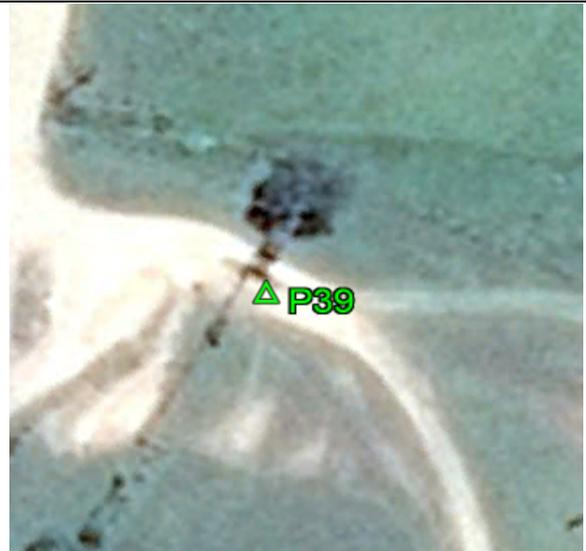
**Fecha: 31/03/2017****Modo de Levantamiento: RTK****Tipo / Modelo de antena utilizado: Trimble/ R6-4 Internal****Altura / Tipo de Medición de la antena: 2,000 / Base del montaje****Nombre de archivo Rinex: -****Observaciones: Punto recogido en la esquina de la mureta. Todas las unidades están en metros.****Ejecutado por:****Topocart - Topografía, Engenharia e Aerolevantamento S/S Ltda.**
