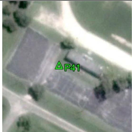
**Fecha:** 21/04/2017**Modo de Levantamiento:** RTK**Tipo / Modelo de antena utilizado:** Trimble/ R6-4 Internal**Altura / Tipo de Medición de la antena:** 2,000 / Base del montaje**Nombre de archivo Rinex:** -**Observaciones:** Punto recogido en el terreno. Todas las unidades están en metros.**Ejecutado por:****Topocart - Topografía, Engenharia e Aerolevantamento S/S Ltda.**
