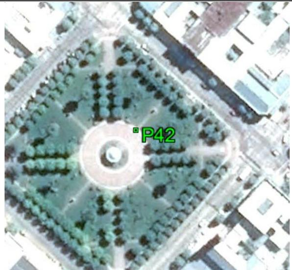
**Fecha: 03/03/2017****Modo de Levantamiento: RTK****Tipo / Modelo de antena utilizado: Trimble/ R6-4 Internal****Altura / Tipo de Medición de la antena: 2,000 / Base del montaje****Nombre de archivo Rinex: -****Observaciones: Punto recogido en la esquina de la calzada. Todas las unidades están en metros.****Ejecutado por:****Topocart - Topografía, Engenharia e Aerolevantamento S/S Ltda.**
