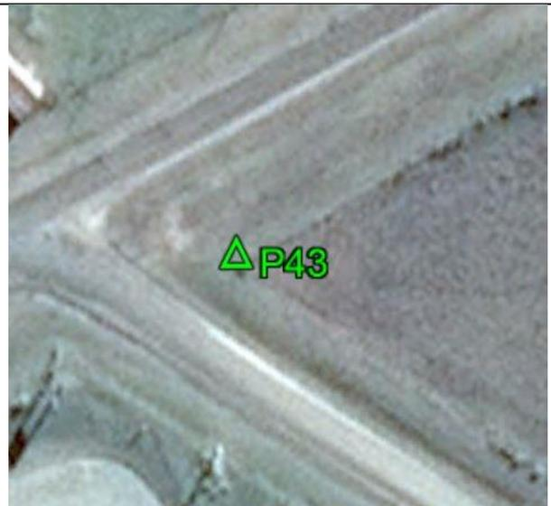
**Fecha:** 20/04/2017**Modo de Levantamiento:** RTK**Tipo / Modelo de antena utilizado:** Trimble/ R6-4 Internal**Altura / Tipo de Medición de la antena:** 2,000 / Base del montaje**Nombre de archivo Rinex:** -**Observaciones:** Punto recogido en la esquina de la cerca. Todas las unidades están en metros.**Ejecutado por:****Topocart - Topografía, Engenharia e Aerolevanteamento S/S Ltda.**
