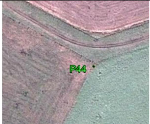
**Fecha:** 20/04/2017**Modo de Levantamiento:** GPS**Tipo / Modelo de antena utilizado:** Trimble R6-4 Internal / AR20 w/LEIM Dome**Altura / Tipo de Medición de la antena:** 2,000m / Base del montaje**Nombre de archivo Rinex:** P44\_1100**Observaciones:** Punto recogido en la esquina de la cerca. Todas las unidades están en metros.**Ejecutado por:****Topocart - Topografía, Engenharia e Aerolevantamento S/S Ltda.**
