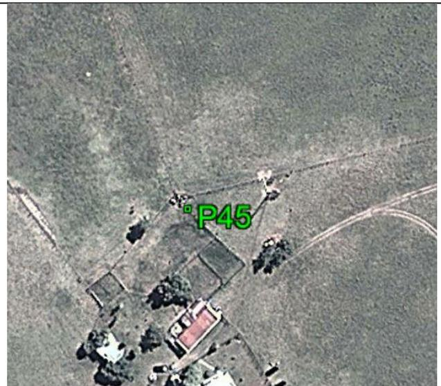
**Fecha: 14/02/2017****Modo de Levantamiento: RTK****Tipo / Modelo de antena utilizado: Trimble/ R6-4 Internal****Altura / Tipo de Medición de la antena: 2,000 / Base del montaje****Nombre de archivo Rinex: -****Observaciones: Punto recogido en la esquina de la cerca. Todas las unidades están en metros.****Ejecutado por:****Topocart - Topografía, Ingeniería e Aerolevantamiento S/S Ltda.**
