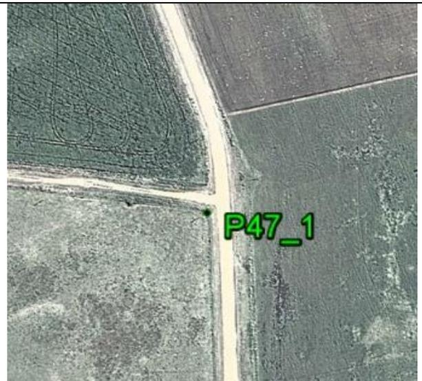
**Fecha: 15/02/2017****Modo de Levantamiento: RTK****Tipo / Modelo de antena utilizado: Trimble R6-4 Internal / AR20 w/LEIM Dome****Altura / Tipo de Medición de la antena: 2,000m / Base del montaje****Nombre de archivo Rinex: -****Observaciones: Punto recogido en la esquina de la cerca. Todas las unidades están en metros****Ejecutado por:****Topocart - Topografía, Engenharia e Aerolevantamento S/S Ltda.**
