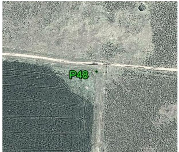
**Fecha: 15/02/2017****Modo de Levantamiento: RTK****Tipo / Modelo de antena utilizado: Trimble R6-4 Internal / AR20 w/LEIM Dome****Altura / Tipo de Medición de la antena: 2,000m / Base del montaje****Nombre de archivo Rinex: -****Observaciones: Punto recogido en la esquina de la cerca. Todas las unidades están en metros.****Ejecutado por:****Topocart - Topografía, Engenharia e Aerolevanteamento S/S Ltda.**
