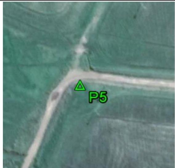
**Fecha: 22/02/2018****Modo de Levantamiento: Estático****Tipo / Modelo de antena utilizado: Trimble/ R6-4 Internal****Altura / Tipo de Medición de la antena: 2,000 / Base del montaje****Nombre de archivo Rinex: P5\_0535****Observaciones: Punto recogido en la esquina de la cerca. Todas las unidades estan en metros.****Ejecutado por:****Topocart - Topografía, Engenharia e Aerolevantamento S/S Ltda.**
