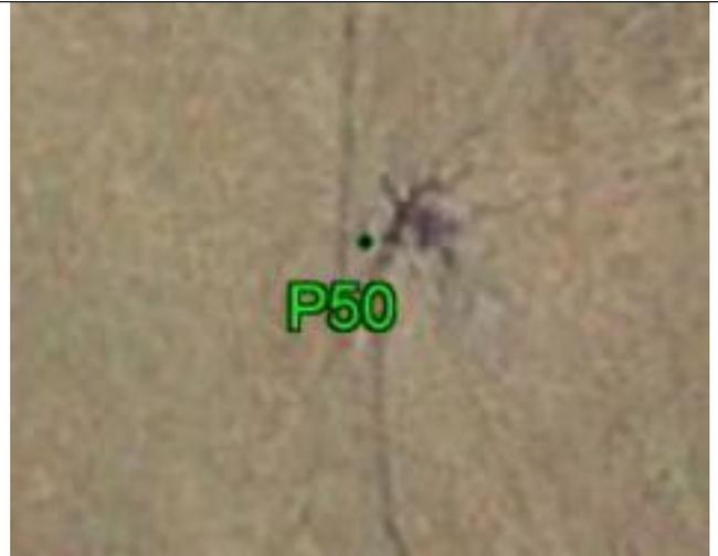
**Fecha:** 24/03/2017**Modo de Levantamiento:** RTK**Tipo / Modelo de antena utilizado:** Trimble R6-4 Internal / AR20 w/LEIM Dome**Altura / Tipo de Medición de la antena:** 2,000m / Base del montaje**Nombre de archivo Rinex:** -**Observaciones:** Punto recogido en la esquina de la cerca. Todas las unidades están en metros.**Ejecutado por:****Topocart - Topografía, Engenharia e Aerolevantamento S/S Ltda.**
