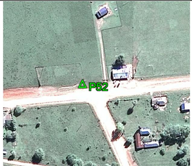
**Fecha: 14/02/2018****Modo de Levantamiento: Estático****Tipo / Modelo de antena utilizado: Trimble/ R6-4 Internal****Altura / Tipo de Medición de la antena: 2,000 / Base del montaje****Nombre de archivo Rinex: P52\_0450****Observaciones: Punto recogido en la esquina de la cerca. Todas las unidades están en metros.****Ejecutado por:****Topocart - Topografía, Engenharia e Aerolevantamento S/S Ltda.**
