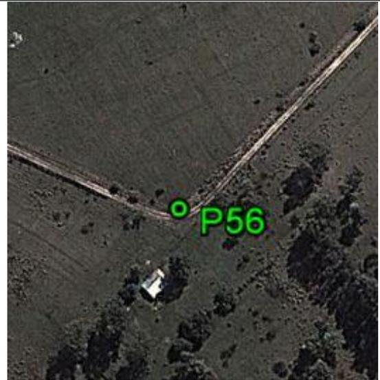
**Fecha:** 31/03/2017**Modo de Levantamiento:** RTK**Tipo / Modelo de antena utilizado:** Trimble/ R8s Internal**Altura / Tipo de Medición de la antena:** 2,000 / Base del montaje**Nombre de archivo Rinex:** -**Observaciones:** Punto recogido en la esquina de la cerca. Todas las unidades están en metros**Ejecutado por:****Topocart - Topografía, Engenharia e Aerolevanteamento S/S Ltda.**
