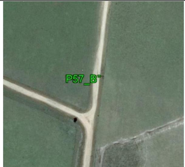
**Fecha: 02/03/2017****Modo de Levantamiento: RTK****Tipo / Modelo de antena utilizado: Trimble/ R6-4 Internal****Altura / Tipo de Medición de la antena: 2,000 / Base del montaje****Nombre de archivo Rinex: -****Observaciones: Punto recogido en la esquina de la cerca. Todas las unidades están en metros.****Ejecutado por:****Topocart - Topografía, Engenharia e Aerolevantamento S/S Ltda.**
