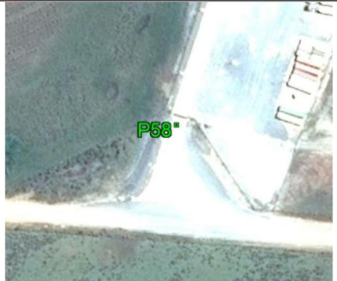
**Fecha: 02/03/2017****Modo de Levantamiento: RTK****Tipo / Modelo de antena utilizado: Trimble/ R6-4 Internal****Altura / Tipo de Medición de la antena: 2,000 / Base del montaje****Nombre de archivo Rinex: -****Observaciones: El punto fue tomado en el canto del puente. Todas las unidades están en metros.****Ejecutado por:****Topocart - Topografía, Engenharia e Aerolevantamento S/S Ltda.**
