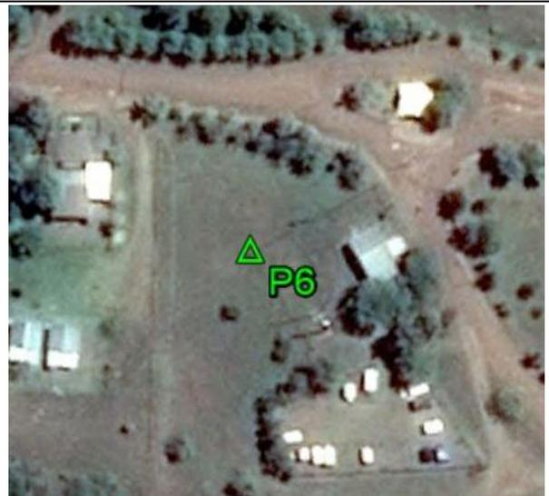
**Fecha: 22/02/2018****Modo de Levantamiento: Estático****Tipo / Modelo de antena utilizado: Trimble/ R6-4 Internal****Altura / Tipo de Medición de la antena: 2,000 / Base del montaje****Nombre de archivo Rinex: P6\_0530****Observaciones: Punto recogido en la esquina de la cerca. Todas las unidades estan en metros.****Ejecutado por:****Topocart - Topografía, Engenharia e Aerolevantamento S/S Ltda.**
