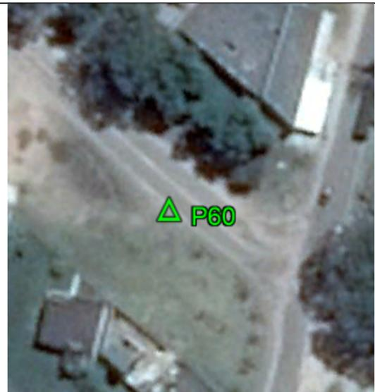
**Fecha: 16/02/2018****Modo de Levantamiento: Estático****Tipo / Modelo de antena utilizado: Trimble/ R8s Internal****Altura / Tipo de Medición de la antena: 2,000 / Base del montaje****Nombre de archivo Rinex: P60\_0470****Observaciones: Punto recogido en el canto de la plataforma. Todas las unidades están en metros.****Ejecutado por:****Topocart - Topografía, Engenharia e Aerolevantamento S/S Ltda.**
