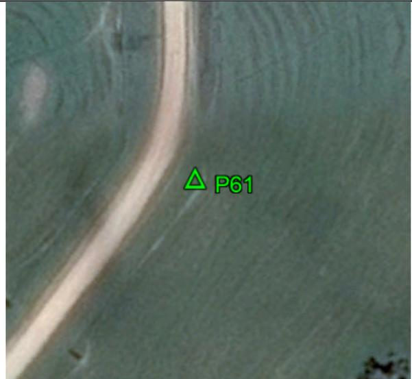
**Fecha: 16/02/2018****Modo de Levantamiento: Estático****Tipo / Modelo de antena utilizado: Trimble/ R8s Internal****Altura / Tipo de Medición de la antena: 2,000 / Base del montaje****Nombre de archivo Rinex: P61\_0473****Observaciones: Punto recogido en la esquina de la cerca. Todas las unidades están en metros.****Ejecutado por:****Topocart - Topografía, Engenharia e Aerolevantamento S/S Ltda.**
