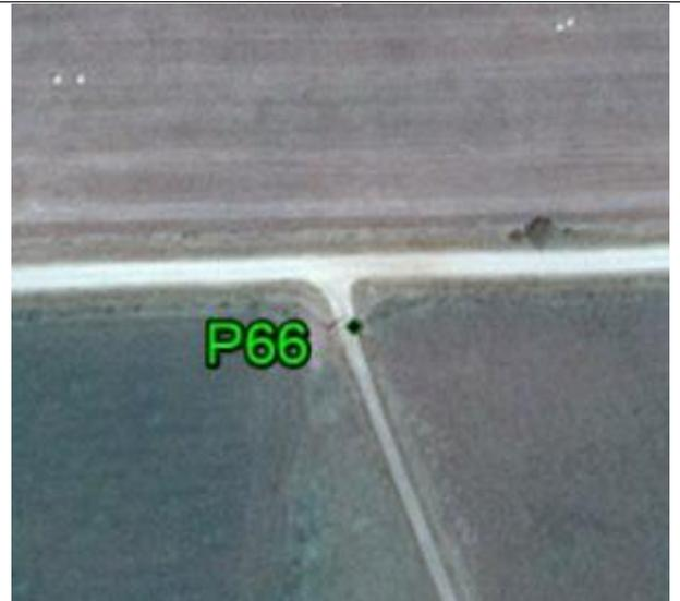
**Fecha: 28/01/2017****Modo de Levantamiento: Estático****Tipo / Modelo de antena utilizado: Trimble/ R6-4 Internal****Altura / Tipo de Medición de la antena: 2,000 / Base del montaje****Nombre de archivo Rinex: 66\_0282****Observaciones: Punto recogido en la esquina de la cerca. Todas las unidades están en metros****Ejecutado por:****Topocart - Topografía, Engenharia e Aerolevanteamento S/S Ltda.**
