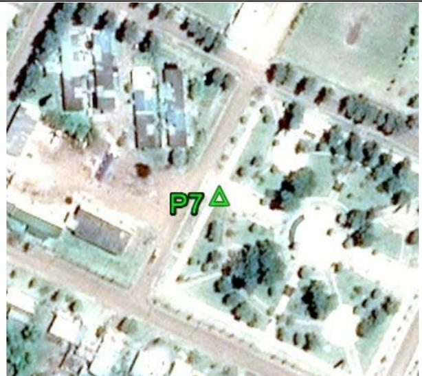
**Fecha: 07/04/2018****Modo de Levantamiento: Estático****Tipo / Modelo de antena utilizado: Trimble/ R6-4 Internal****Altura / Tipo de Medición de la antena: 2,000 / Base del montaje****Nombre de archivo Rinex: P7\_0974****Observaciones: Punto recogido en el canto de la calzada. Todas las unidades estan en metros.****Ejecutado por:****Topocart - Topografía, Engenharia e Aerolevantamento S/S Ltda.**
