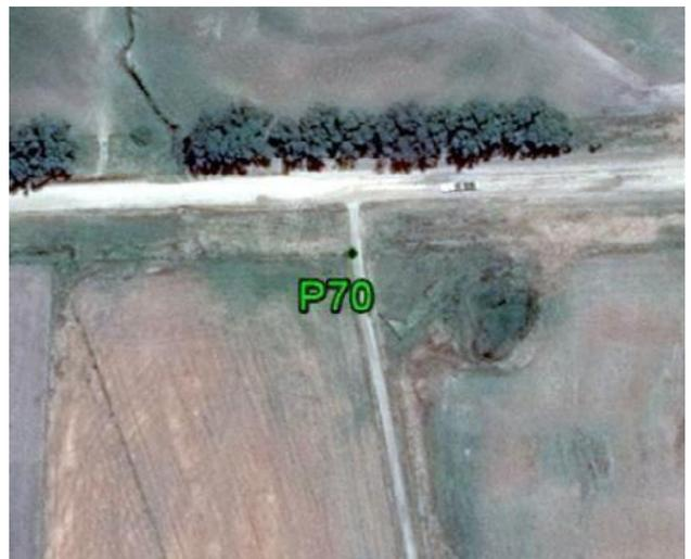
**Fecha: 15/02/2017****Modo de Levantamiento: RTK****Tipo / Modelo de antena utilizado: Trimble R6-4 Internal / AR20 w/LEIM Dome****Altura / Tipo de Medición de la antena: 2,000m / Base del montaje****Nombre de archivo Rinex: -****Observaciones: Punto recogido en la esquina de la pared. Todas las unidades están en metros.****Ejecutado por:****Topocart - Topografía, Engenharia e Aerolevantamento S/S Ltda.**
