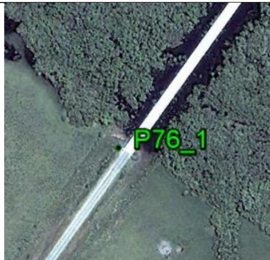
**Fecha: 15/02/2017****Modo de Levantamiento: RTK****Tipo / Modelo de antena utilizado: Trimble R6-4 Internal / AR20 w/LEIM Dome****Altura / Tipo de Medición de la antena: 2,000m / Base del montaje****Nombre de archivo Rinex: -****Observaciones: Punto recogido en la esquina de la acera. Todas las unidades están en metros.****Ejecutado por:****Topocart - Topografía, Engenharia e Aerolevantamento S/S Ltda.**
