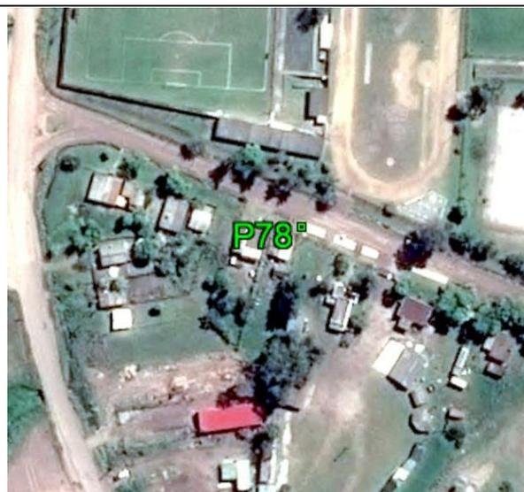
**Fecha: 02/03/2017****Modo de Levantamiento: RTK****Tipo / Modelo de antena utilizado: Trimble/ R6-4 Internal****Altura / Tipo de Medición de la antena: 2,000 / Base del montaje****Nombre de archivo Rinex: -****Observaciones: El punto fue tomado en el canto de la planchada. Todas las unidades están en metros.****Ejecutado por:****Topocart - Topografía, Engenharia e Aerolevanteamento S/S Ltda.**
