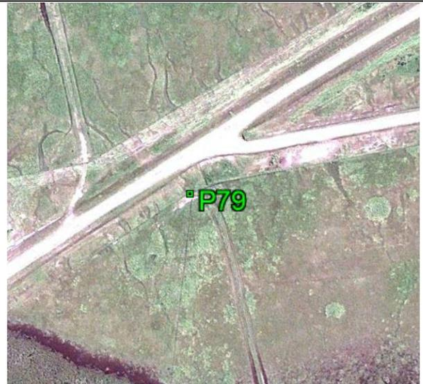
**Fecha: 02/03/2017****Modo de Levantamiento: RTK****Tipo / Modelo de antena utilizado: Trimble/ R6-4 Internal****Altura / Tipo de Medición de la antena: 2,000 / Base del montaje****Nombre de archivo Rinex: -****Observaciones: El punto fue recogido en la esquina de la cerca. Todas las unidades están en metros.****Ejecutado por:****Topocart - Topografía, Engenharia e Aerolevantamento S/S Ltda.**
