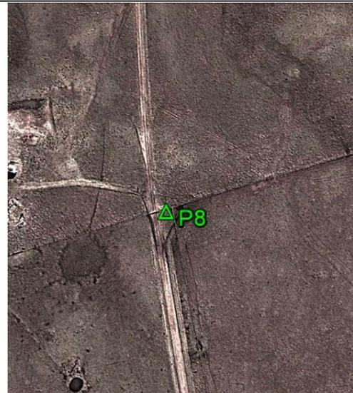
**Fecha:** 27/02/2018**Modo de Levantamiento:** Estático**Tipo / Modelo de antena utilizado:** Trimble/ R6-4 Internal**Altura / Tipo de Medición de la antena:** 2,000 / Base del montaje**Nombre de archivo Rinex:** P8\_0580**Observaciones:** Punto recogido en el terreno. Todas las unidades están en metros.**Ejecutado por:****Topocart - Topografía, Engenharia e Aerolevantamento S/S Ltda.**
