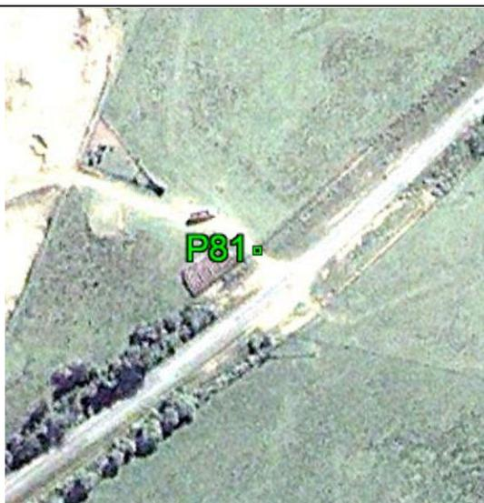
**Fecha: 02/03/2017****Modo de Levantamiento: RTK****Tipo / Modelo de antena utilizado: Trimble/ R6-4 Internal****Altura / Tipo de Medición de la antena: 2,000 / Base del montaje****Nombre de archivo Rinex: -****Observaciones: Punto recogido en la esquina de la cerca. Todas las unidades están en metros.****Ejecutado por:****Topocart - Topografía, Engenharia e Aerolevantamento S/S Ltda.**
