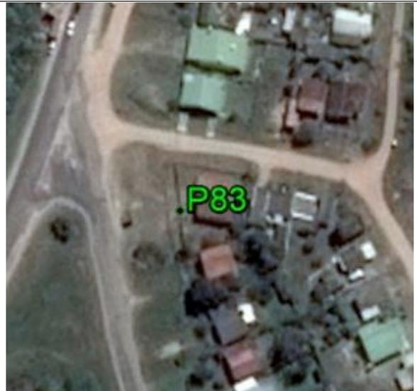
**Fecha: 23/02/2017****Modo de Levantamiento: RTK****Tipo / Modelo de antena utilizado: Trimble/ R6-4 Internal****Altura / Tipo de Medición de la antena: 2,000 / Base del montaje****Nombre de archivo Rinex: -****Observaciones: Punto recogido en la esquina del cerco. Todas las unidades están en metros.****Ejecutado por:****Topocart - Topografía, Engenharia e Aerolevantamento S/S Ltda.**
