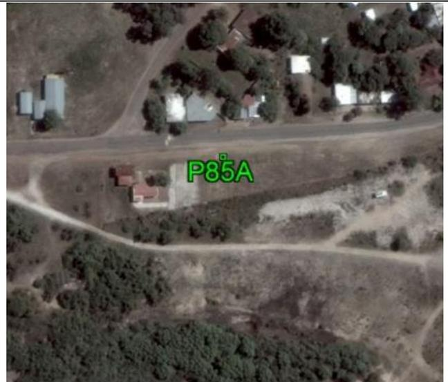
**Fecha: 23/02/2017****Modo de Levantamiento: RTK****Tipo / Modelo de antena utilizado: Trimble/ R6-4 Internal****Altura / Tipo de Medición de la antena: 2,000 / Base del montaje****Nombre de archivo Rinex: -****Observaciones: El punto fue recogido en la esquina del pavimento. Todas las unidades están en metros.****Ejecutado por:****Topocart - Topografía, Engenharia e Aerolevanteamento S/S Ltda.**
