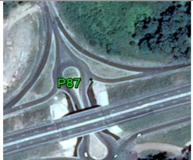
**Fecha: 28/01/2017****Modo de Levantamiento: Estático****Tipo / Modelo de antena utilizado: Trimble/ R6-4 Internal****Altura / Tipo de Medición de la antena: 2,000 / Base del montaje****Nombre de archivo Rinex: 87\_0281****Observaciones: Punto recogido en la esquina de la acera. Todas las unidades están en metros.****Ejecutado por:****Topocart - Topografía, Engenharia e Aerolevantamento S/S Ltda.**
