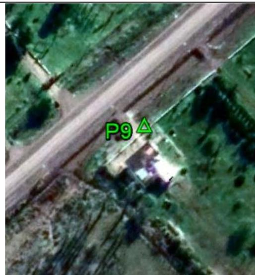
**Fecha: 27/02/2018****Modo de Levantamiento: Estático****Tipo / Modelo de antena utilizado: Trimble/ R6-4 Internal****Altura / Tipo de Medición de la antena: 2,000 / Base del montaje****Nombre de archivo Rinex: P9\_0581****Observaciones: Punto recogido en la esquina de la mureta. Todas las unidades están en metros.****Ejecutado por:****Topocart - Topografía, Engenharia e Aerolevanteamento S/S Ltda.**
